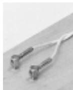
Точка замера влажности древесины с забивными электродами
